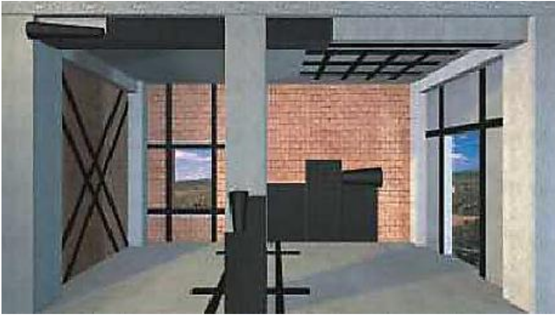
الشكل (20-2): تقوية العناصر الإنشائية باستخدام مادة FRP.
