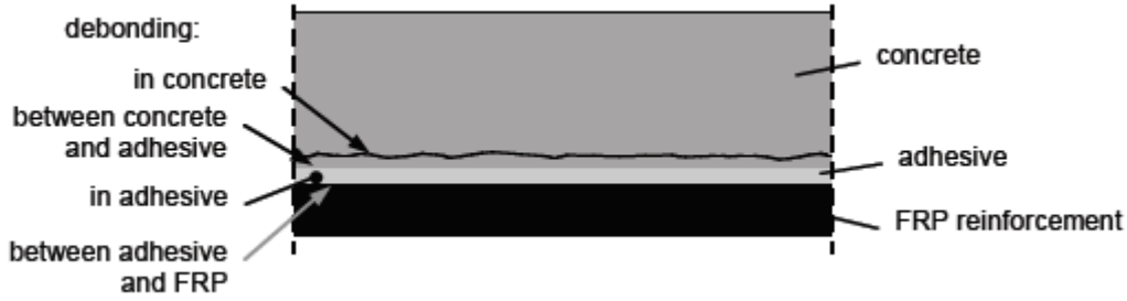
الشكل (21-3): التشقق في منطقة اتصال مادة FRP بالبيتون. (CEB-FIP, 2010)
